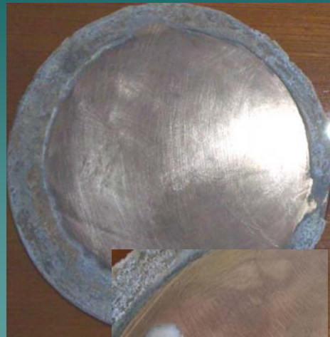
Regenerierte Sinterplatte mechanisch gereinigt und mit HCl gespült
